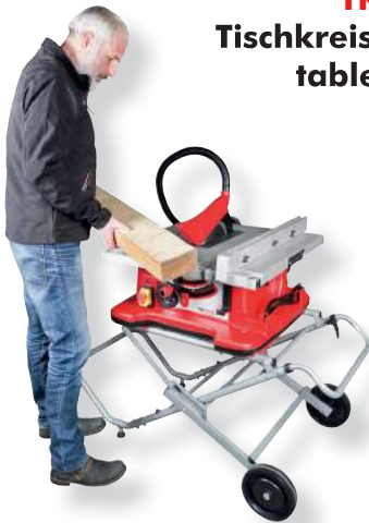
TS 400Z Zimmerer-Tischkreissäge/ carpenter table saw
